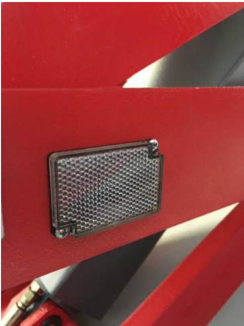
Fig. 10 - Montering af refleksglas og fotosensor
