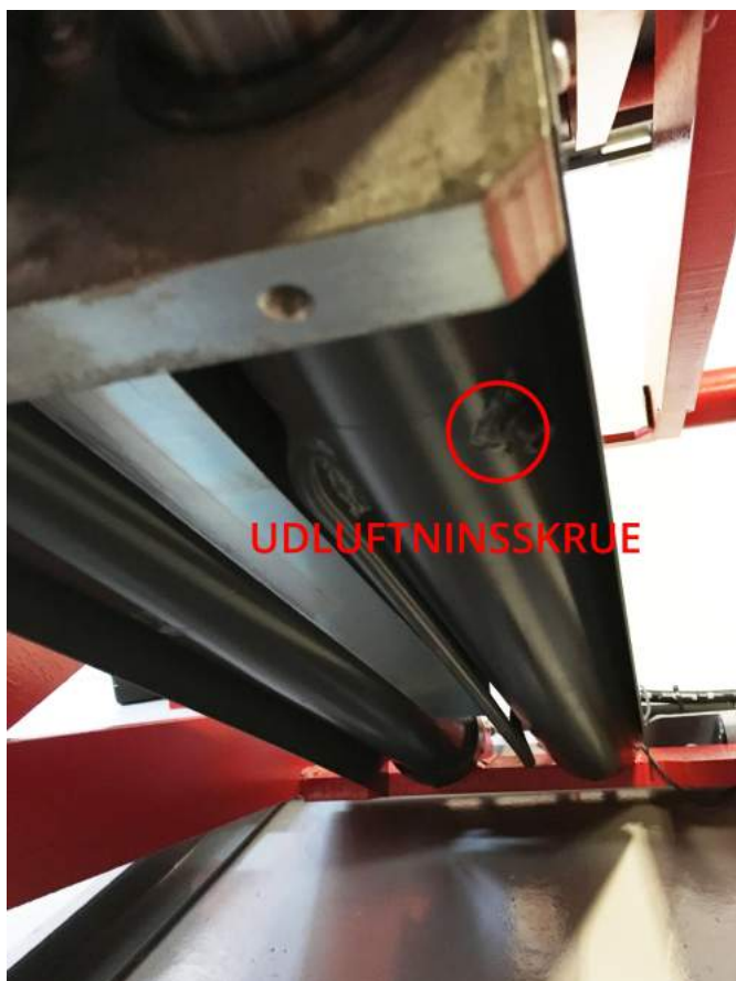
Fig. 15 - Udluftning af hydrauliksystem
