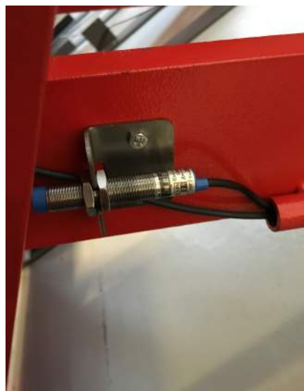
Fig. 5 – Montering af fodsensor
