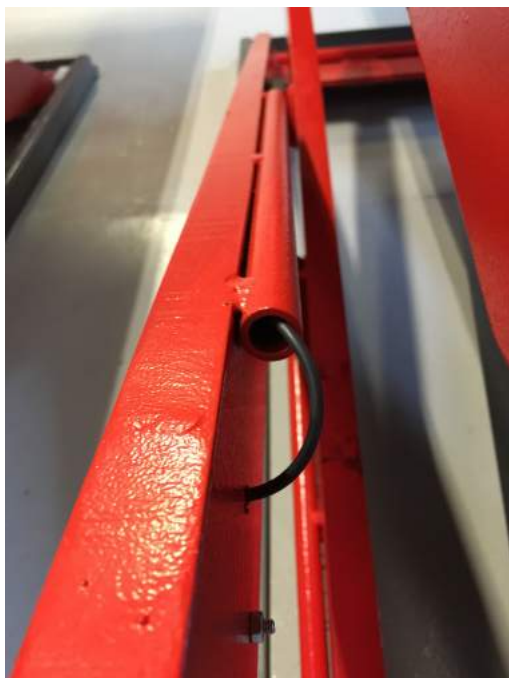
Fig. 11 – Føring af kabel til fotosensor.
