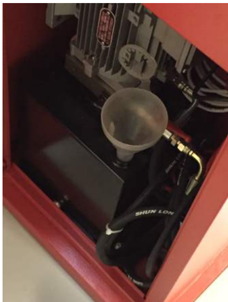
Fig. 14 – Påfyldning af hydraulikolie
